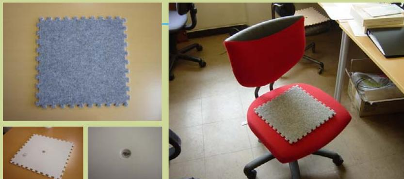
着席している人の体温が座面に伝わることに着目し、クッション（またはそれに似たもの）に1ボタンを設置して温度計測し、その席における在・不在を判別する
