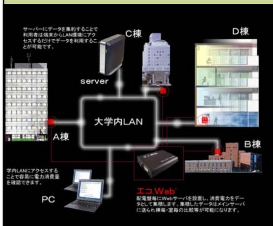
大学施設のネットワークを利用してエネルギー計測システムを構築した。変電所、大学建物などにWebサーバを設置し、既設の通信回線の利用と安価なWebサーバの利用でシステムコストを抑え、エネルギーデータは大学内のデータサーバに集約し、解析データを学内ネットワーク上から大学職員や学生など一般の利用者が容易に参照できるシステムになっている。このシステムにより、どの場所で無駄遣いが行われているか把握することが可能になる。
